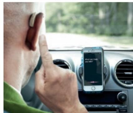
Die neue Tap Control der Phonak Audéo Paradise Hörgeräte bietet dem Nutzer einen einfachen Zugriff auf die Bluetooth-Funktionen. „Ein Bewegungssensor im Hörgerät ermöglicht lediglich durch einen Doppeltipp auf die Ohrmuschel das mühelose Annehmen eines Telefonanrufs, die Aktivierung eines Sprachassistenten aber auch das Pausieren oder Fortsetzen von Musik-Streamings“, erklärt der Experte Rolf Martin Schumacher.
